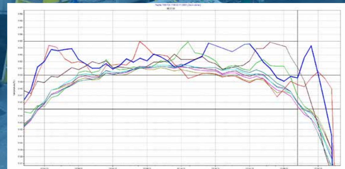
TUS bei 1.150^\circ\text{C} (AMS 2750H Klasse 2, 30 Minuten Verweildauer in den Einweichzonen)
